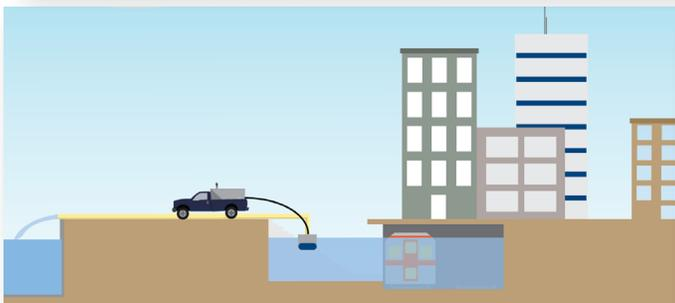
In dieser Situation saugt die "Otter" Pumpe hydraulisch Wasser aus einer unterirdischen Bahnanlage oder anderer Infrastruktur, wie z.b. Entwaesserungs-Noteinsaetze bei Flutbekaempfung oder Migration. Das entzogene Wasser wird dann zu angemessenen Entwaesserungsflaechen transportiert.
